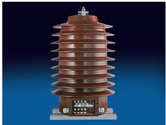
Spannungswandler für Freiluft, mit den charakteristischen Schirren für die äußere Isolation zur Kriechwegverlängerung
